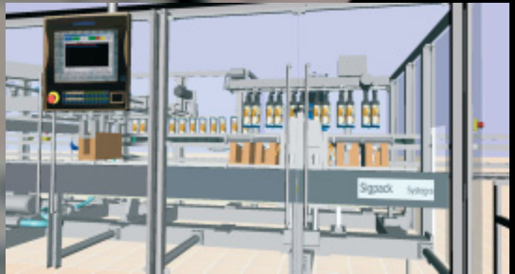
Abb. 1: Beispiel einer virtuellen Maschine: die Getränkeverpackungsanlage. Bild: Daniel Uhlmann
