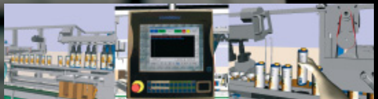
Abb. 2: Unterbruch in der Produktion: In der virtuellen Verpackungsanlage kann die fehlende Flasche von Hand ersetzt werden. Bild: Daniel Uhlmann.
