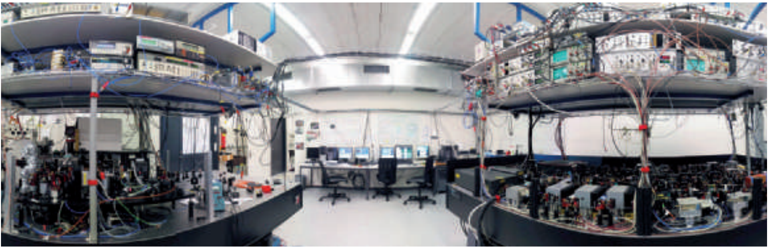
Blick auf den Quantensimulator der Forschungsgruppe von Tilman Esslinger, Professor am Institut für Quantenelektronik der ETH Zürich.
