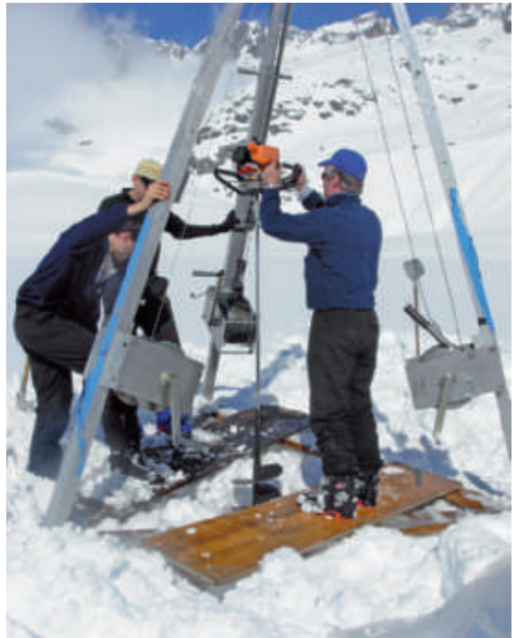
Forscherteam bei der Entnahme von Sedimentkernen aus gefrorenen Bergseen.
