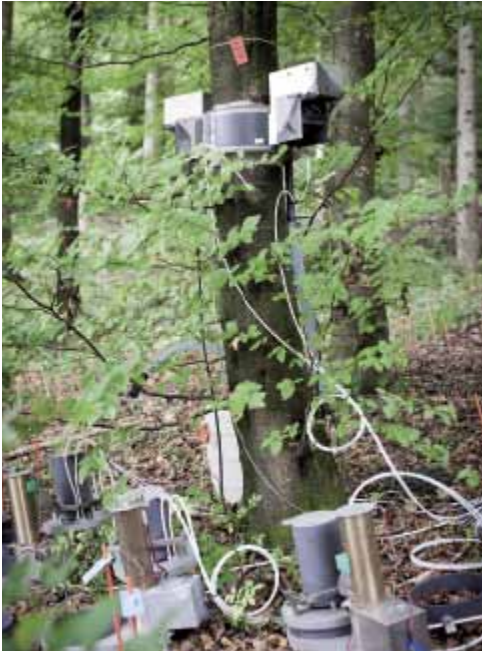
Messinstallation am Baumstamm und im Waldboden.
