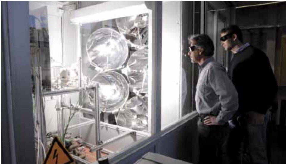
Aldo Steinfeld (links) und Philipp Furler verfolgen ein Experiment mit ihrem solaren thermochemischen Reaktor am Hochfluss-Solarsimulator der ETH Zürich. (Bild: Peter Rüegg / ETH Zürich)
