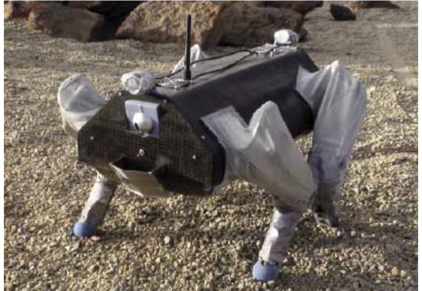
Der an der ETH entwickelte Vierbeiner a.i.f. (autonomer Laufroboter mit Federn) bei einem Praxistest in einem Krater auf Teneriffa. Solche mobilen Maschinen sollen eines Tages zum Beispiel den Mars erkunden. Zum Schutz gegen Staub trägt der Roboter Manschetten.
