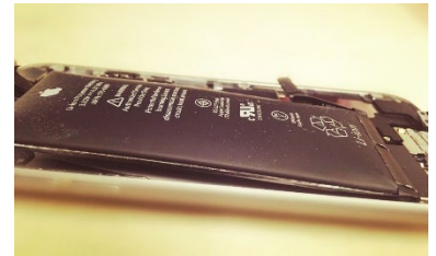
Abbildung 1: Aufgeblähter Lithium-Ionen-Akkumulator (Quelle: SGU)
