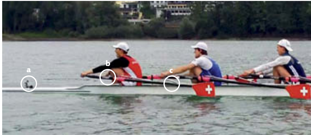
ETHOS, ETH-Orientierungs-Sensor, heisst das etwa streichholzschachtelgrosse Modul, mit dem die Wissenschaftler unter anderem den Schweizer U23-Leichtgewicht-Doppelvierer vermessen haben. Er gewann bei der WM 2011 Bronze. Die Versuche fanden beim Training auf dem Sarnersee statt. Das Bild zeigt die genaue Platzierung der Sensoren an einem Ruder (b) und im Boot selbst (c). Zusätzlich wurde zur Kontrolle eine High-Speed-Videokamera installiert (a).
