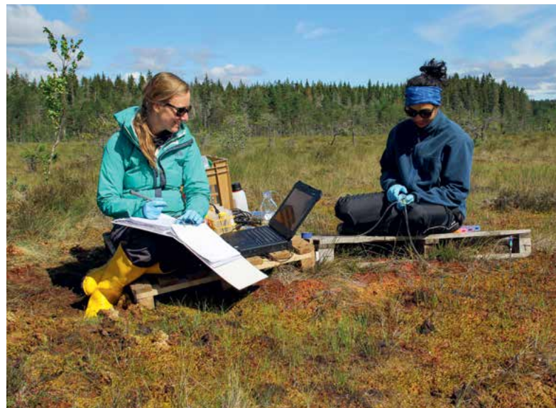
Push-Pull-Test: Meret Aeppli und Prachi Joshi holen injiziertes Wasser aus dem Moorboden und messen die verbleibende Sauerstoffkonzentration.
