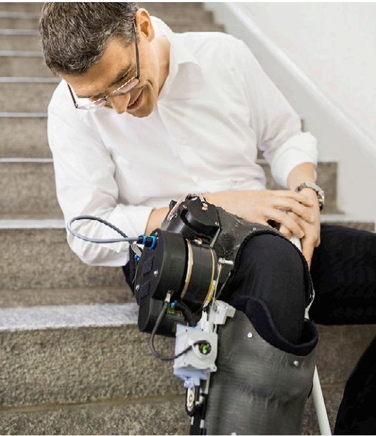
Der «Knee Perturbator» von Professor Gassert untersucht das gesunde Kniegelenk beim Gehen, um daraus bessere Prothesen zu entwickeln.
