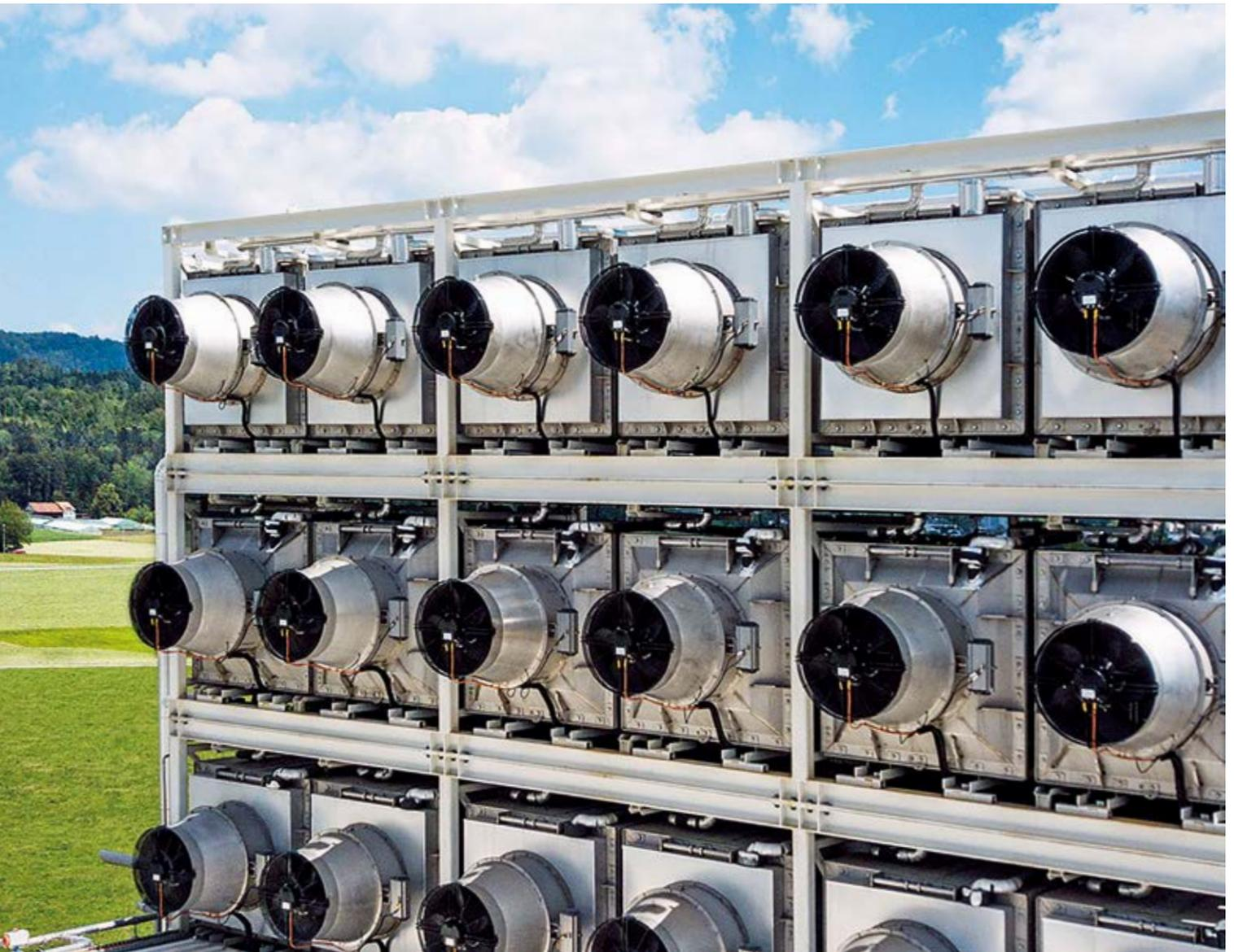
Mit der an der ETH entwickelten Technologie von Climeworks lässt sich bereits emittiertes CO<sub>2</sub> aus der Luft filtern. Das ETH-Spin-off Climeworks gehört zu den sogenannten Einhörnern, d.h. es ist ein Startup mit einer Marktbewertung von über einer Milliarde CHF. (Foto: Climeworks)
