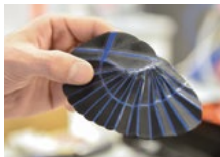
Die 3D-gedruckte Imitation des Ohrwurmflügels lässt sich kompakt falten.
