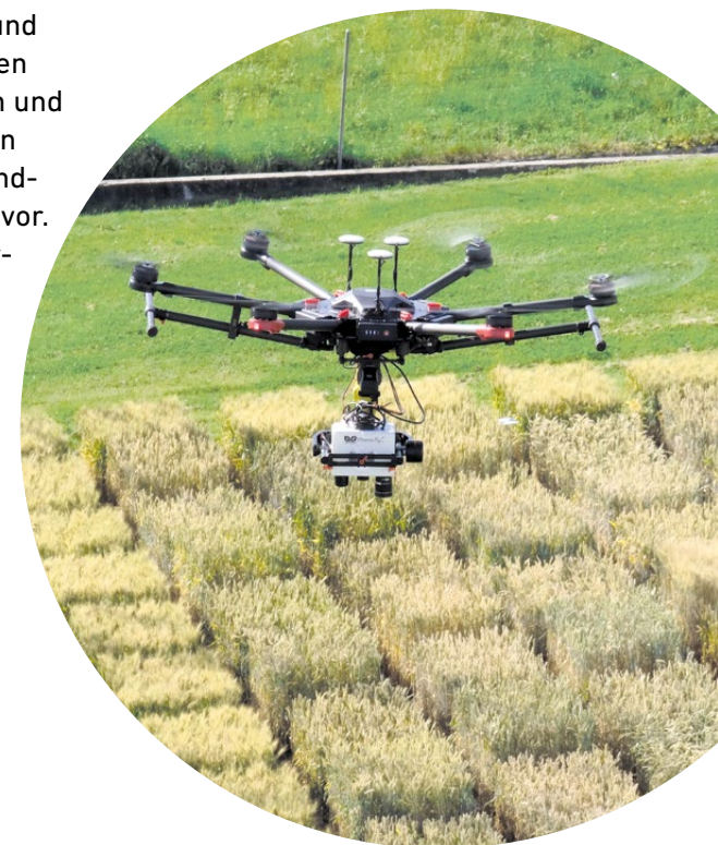
Die Drohne nimmt Luftbilder mit einer Farbkamera und einer Wärmebildkamera auf. So wird über einem Weizen- Versuchsfield bei Zürich erprobt, ob weniger Stickstoffdünger verwendet werden kann. Bild: Norbert Kirchgessner, Helge Aasen
