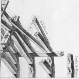
Assemblages des Arbalétriers et Jambes de Forces.
