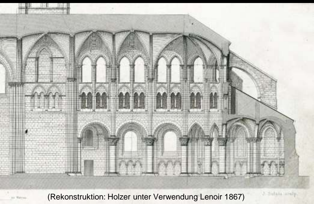
Paris, Saint-Germain-des-Prés, ab 1145. Wandaufbau und Rekonstruktion des Ursprungszustands
