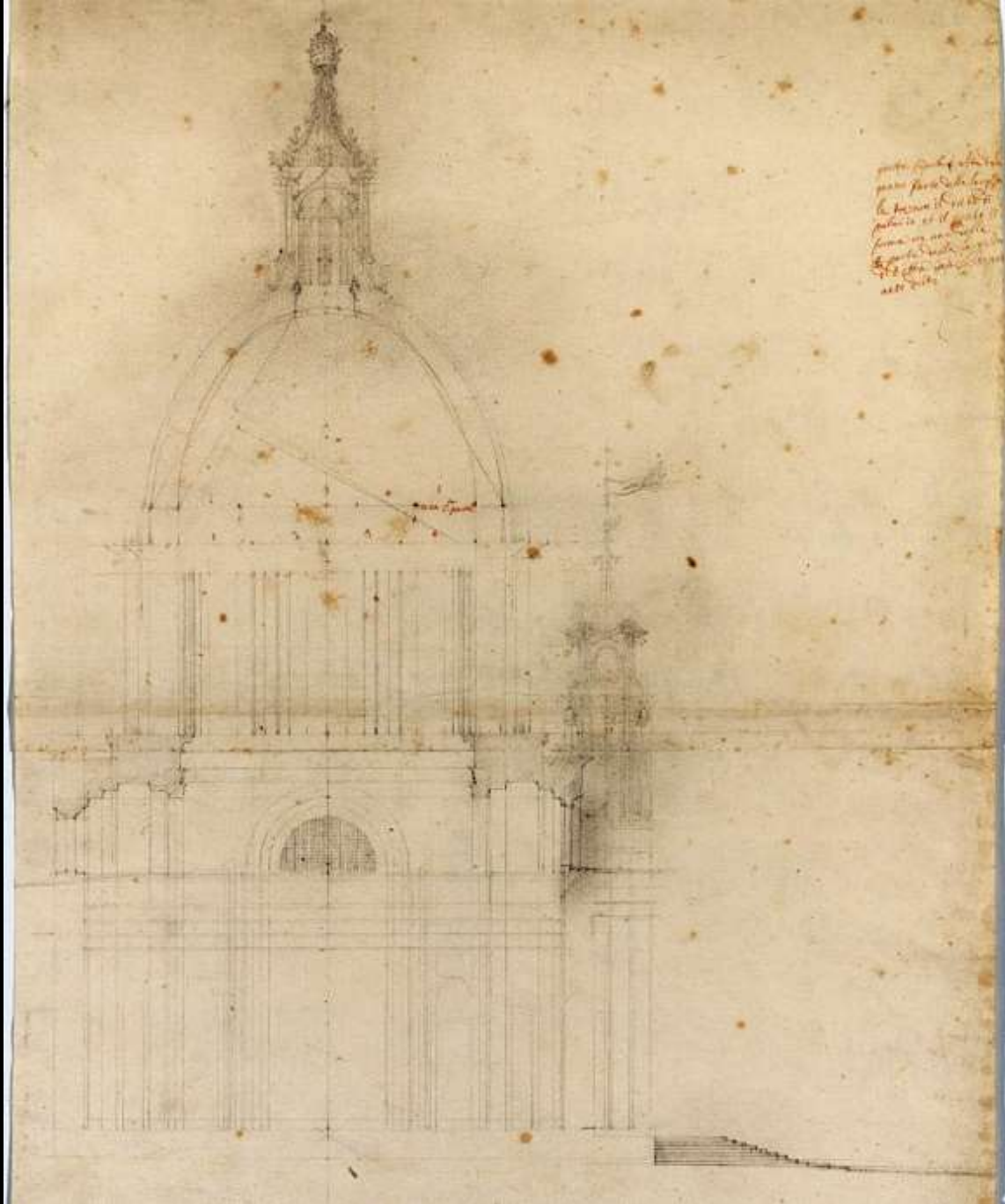
Rom, Sant'Agnese in Agone, Kuppel, Schnitt mit Ovalkontur (Borromini; Albertina Wien Az Rom 59)
