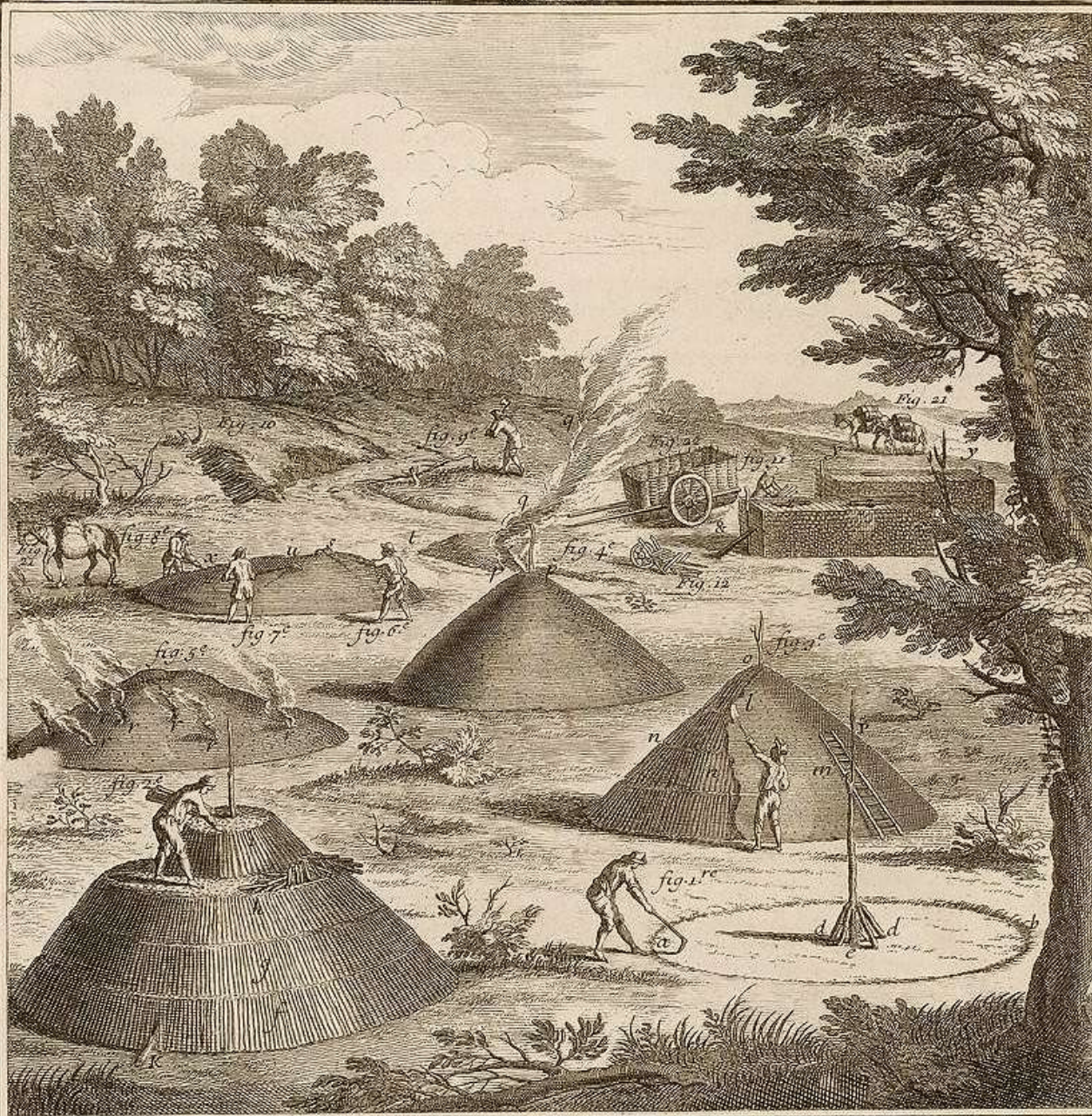
Herstellung von Holzkohle für die Eisenverhüttung in Meilern (Duhamel du Monceau, Art du Charbonnier , 1770)
