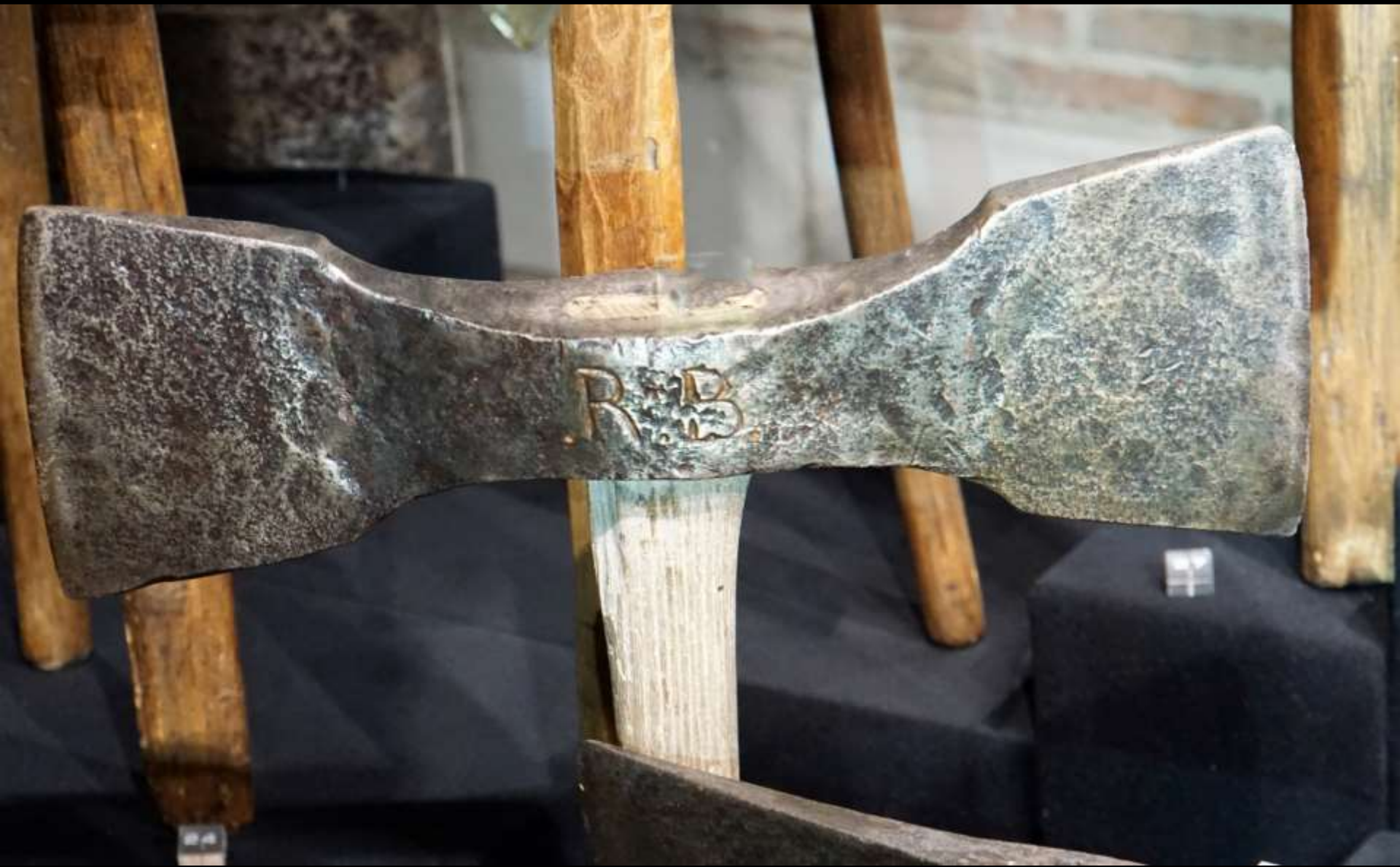
Beil zur Steinbearbeitung: „Glatfläche“ („marteau taillant“; Troyes, Maison de l’Outil)
