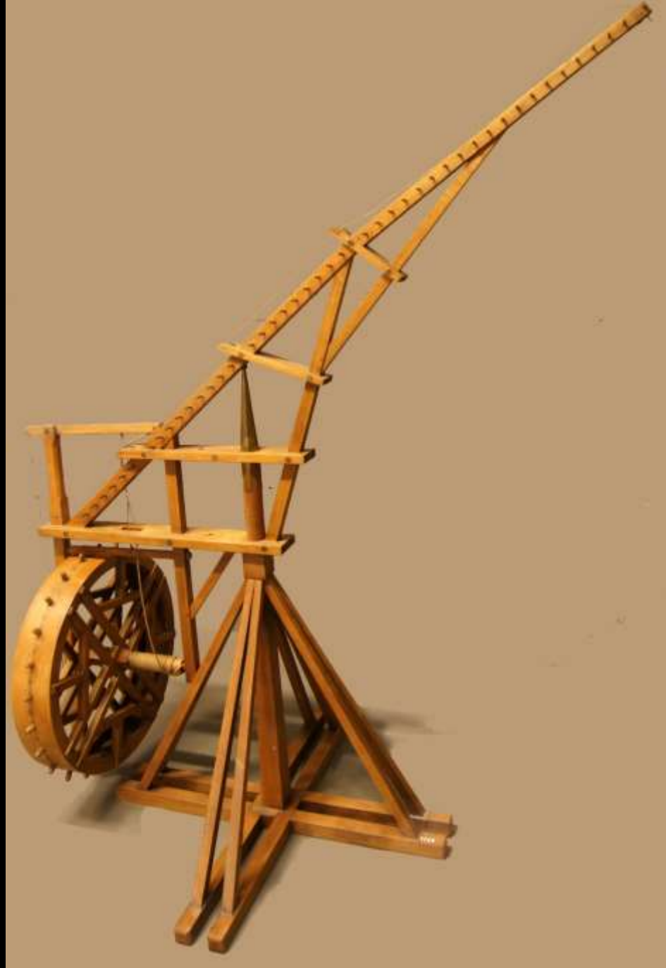
Drehkran mit Tretrad als Gegengewicht (Modell 18. Jh, Paris, Conservatoire des Arts et Métiers)
