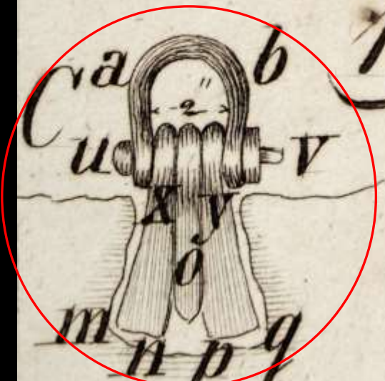
Anschlagmittel (Hebegeschirre) für fertig bearbeitete Quader (Weiß 1820)
