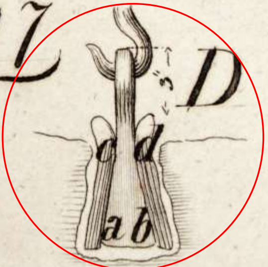
Anschlagmittel (Hebegeschirre) für fertig bearbeitete Quader (Weiß 1820)
