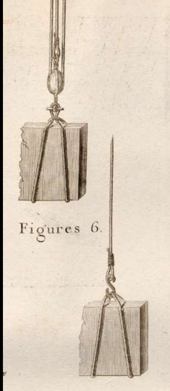
Heben und Versatz von Quadern mit „Kranztau“ (Perronet 1788)
