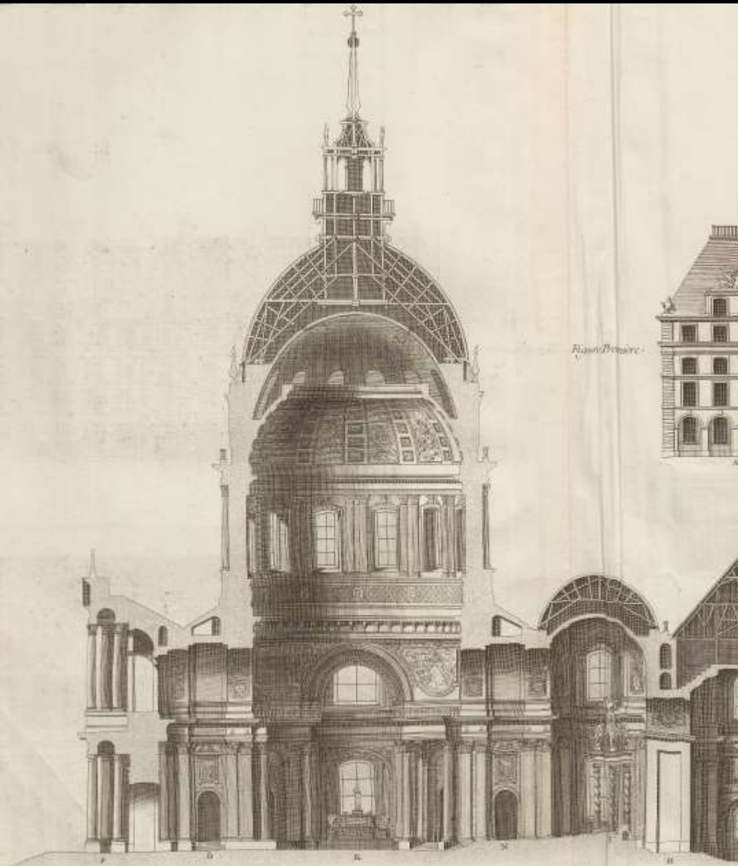
Paris, Invalidendom (1677–91, Jules Hardouin-Mansart; Stich: Blondel 1752). Innere Kuppel in Trommel bzw. Attika eingeschlossen, Aussenkuppel aus Holz
