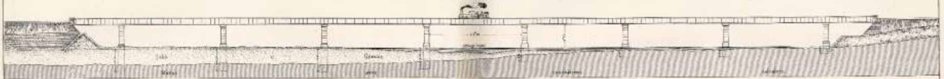
Fig. 1. Elevation générale à 0 003 p m . Longueur totale 2070.
