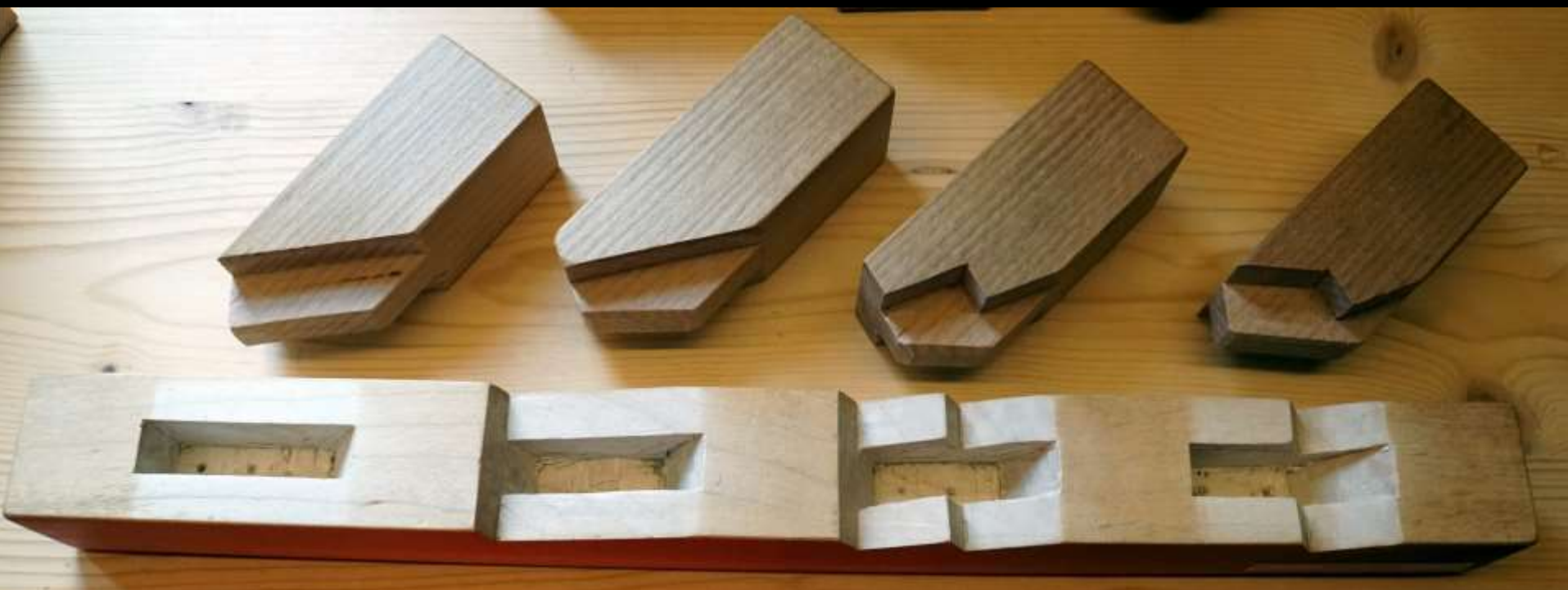
Varianten der schrägen Zapfung mit Versatz/Abstirnung
