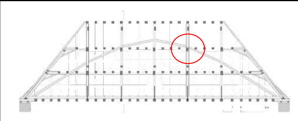
Hinwil ZH, reformierte Kirche (1787). Lichtweite des Saalraums 16.00 m. Längsschnitt des Dachwerks mit Stabbogen
