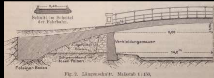
Fig. 2. Längenschnitt. Maßstab 1:150, Centralblatt der Bauverwaltung 1886
