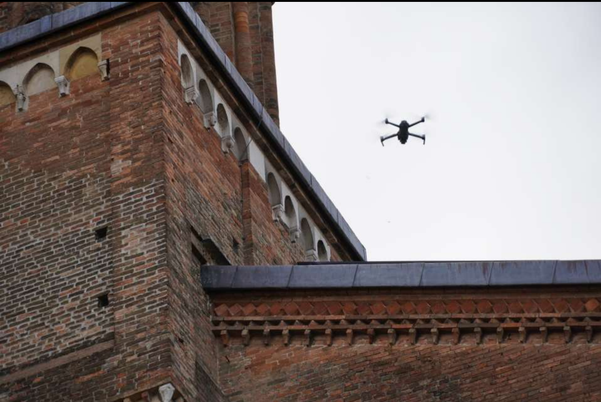
Padua – Basilica Sant'Antonio. Vermessung. Photogrammetrie (structure from motion) für alle Aussenflächen.
