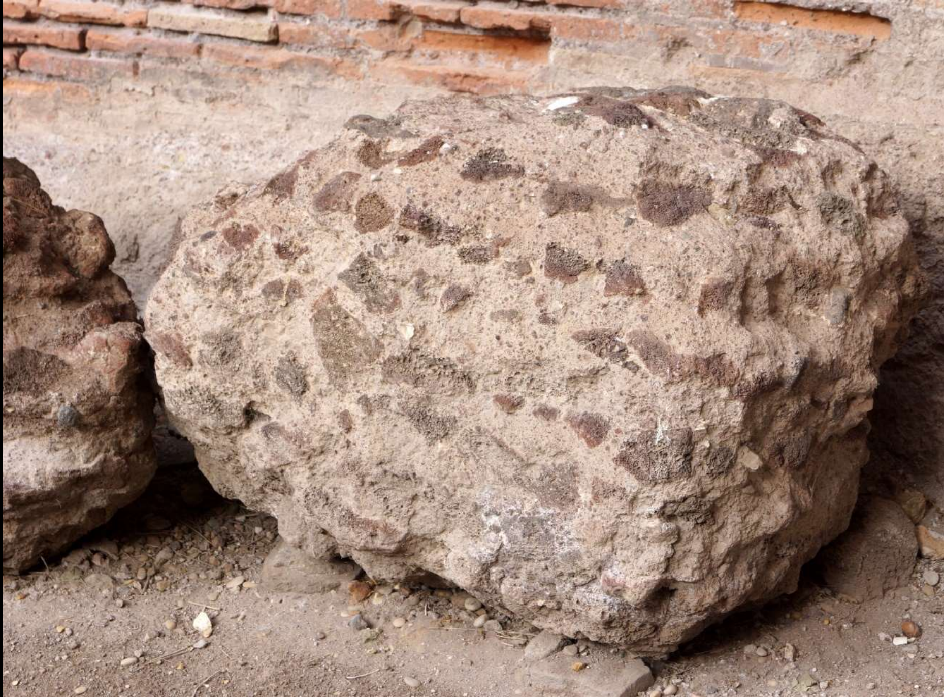
„opus caementicium“ = mörtelreiches Bruchsteinmauerwerk mit hydraulischem Mörtel
