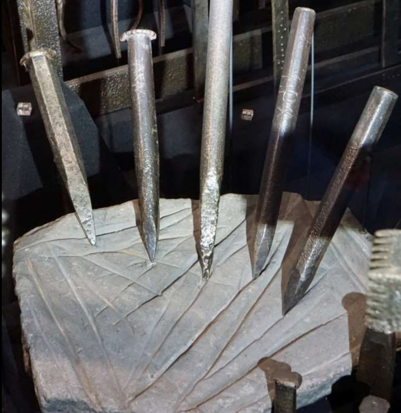
Schlagwerkzeug: Spitzeisen („broche“, „pointe“; Troyes, Maison de l'Outil)
