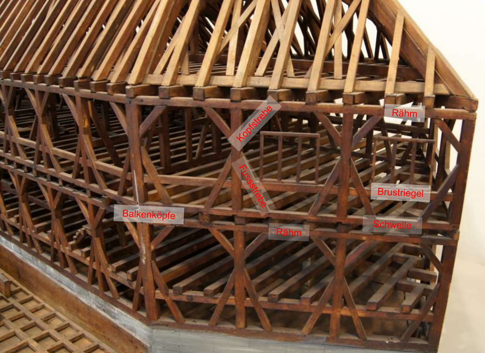
Prinzip des Stockwerksbaus (Modell einer Mühle, 18. Jh., Maximilianmuseum Augsburg)
