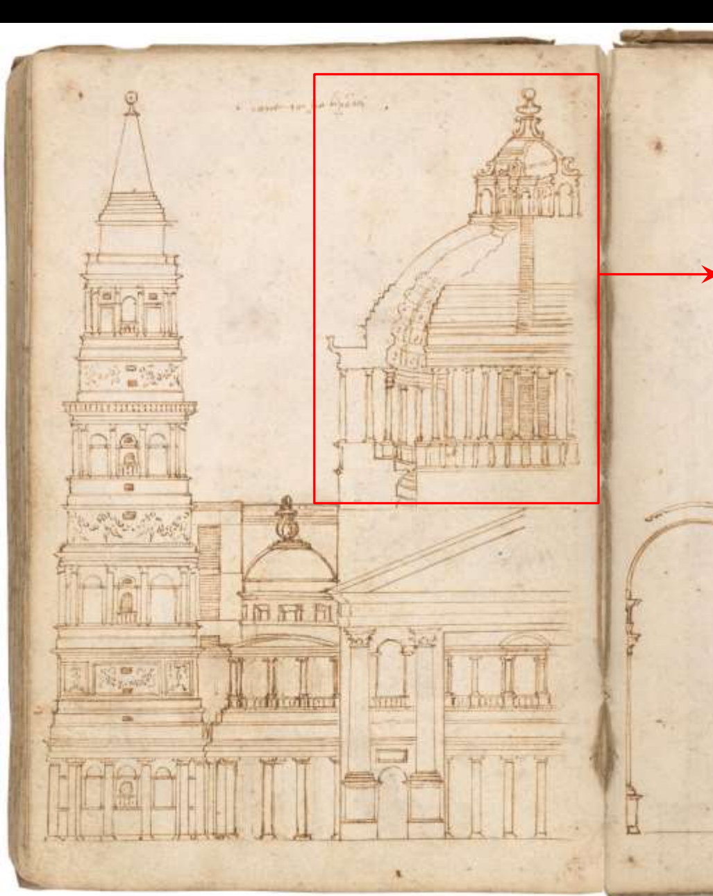
Rom, St. Peter, Entwurf von Bramante: dickschalige „Pantheon“-Kuppel (New York, Pierpont Morgan Library, Codex Mellon, fol. 71 v., um 1513)
