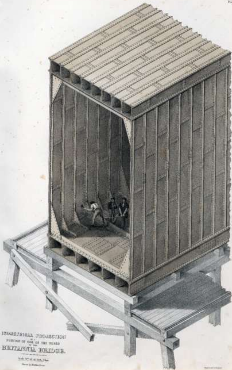
Konstruktion des Blechträgers als ausgesteifter Kasten (links: Britannia Bridge, Clark 1850; rechts: Conway Bridge, Foto: Monika Heim)
