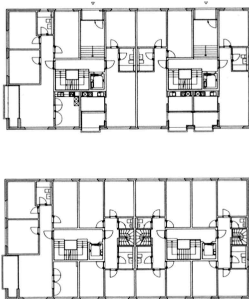
Abbildung 24: Grundrisse Erdgeschoss und Normalgeschoss Haus B2 (PWG)
