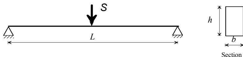
FIG. 6.1: modèle simplifié de la poutre sous poids propre et chargement aléatoire en milieu de travée.
