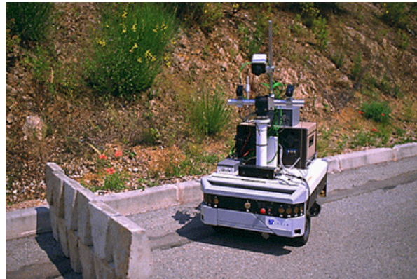
Abb. 31: Autonome Roboter mit binokularem Kamerasystem (Neptune, CMU) und trinokularem Kamerasystem (INRIA)
