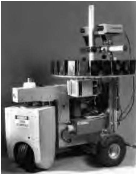
Abb. 31: Autonome Roboter mit binokularem Kamerasystem (Neptune, CMU) und trinokularem Kamerasystem (INRIA)
