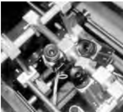
Abb. 10: Dreikamerasystem für 3-D PTV
