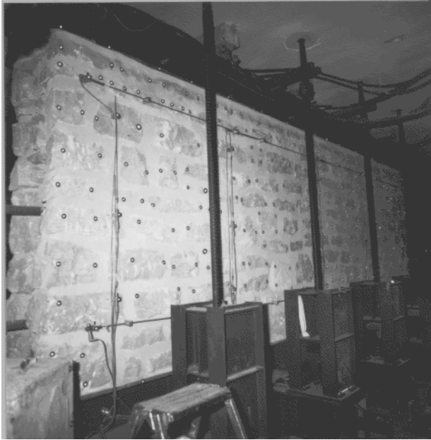
Abb. 15: Mit retroreflektierenden Zielmarken signalisierte Wand: Übersichtsbild und Ausschnitt aus einem Meßbild (Dold/Maas, 1994)
