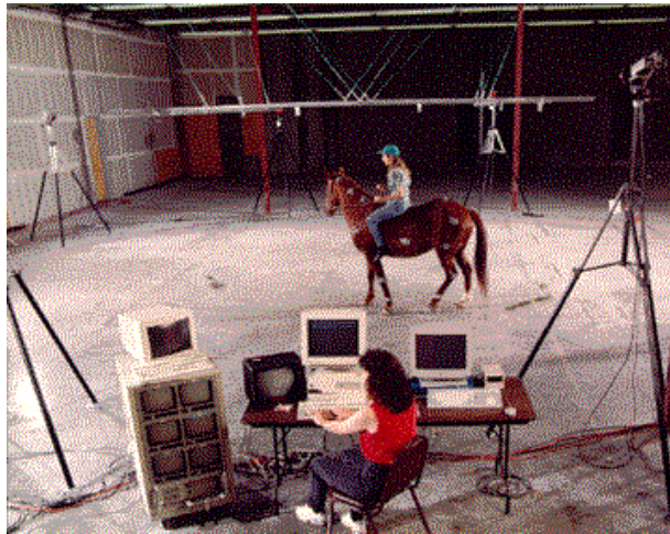
Abb. 28: Mehrkamera-Bewegungsanalysesystem, Referenzstab (Motion Analysis Corp.)
