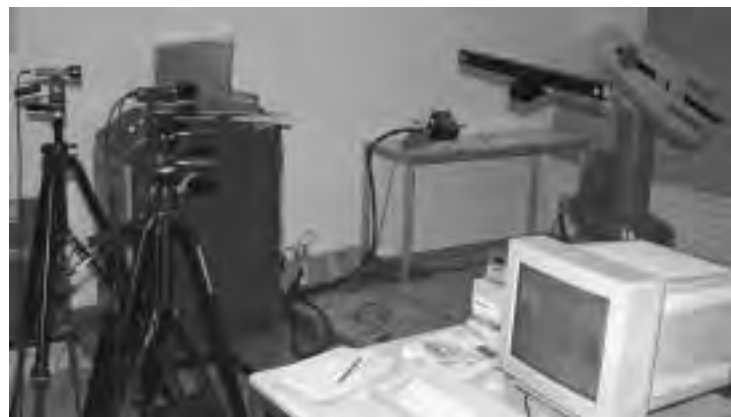
Abb. 27: Referenzstab zur Maßstabsdefinition bei der Selbstkalibrierung eines photogrammetrischen Systems zur Roboterkalibrierung (Maas, 1996b)
