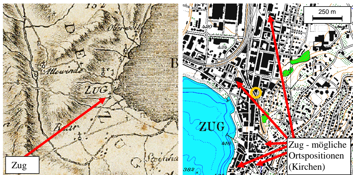
Abb. 5-6: Ein identischer Punkt mit dem Gewicht p_x = p_y = 2/3 in der alten und modernen Karte: Das Stadtzentrum kann nicht eindeutig definiert werden. Da der Lagenunterschied zwischen den möglichen Ortspositionen im Vergleich mit der vorbestimmten mittleren Kartengenauigkeit ( s_0 \approx 460 m) signifikant ist, muss die mittlere Lage dieser Ortspositionen mit dem Wert 2/3 gewichtet werden (gelber Kreis). Links: Carte en Perspective , südorientiert (Anhang B5).
