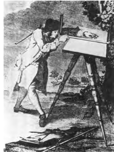
Abb. 6-5: Vermessung mit dem Messtisch, 1751. Aus [Pelletier, 2001].
