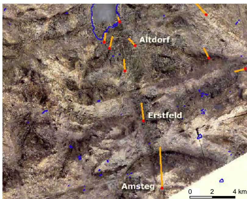
Abb. 6-21: Abweichungen der identischen Punkte des Reliefs der Urschweiz bei der Gotthardroute. Die roten Punkte markieren die heutige Ortslage; die gelben Linien zeigen die entsprechende Position im Relief. Die Visualisierung erfolgt im Landeskoordinatensystem nach der Georeferenzierung des Reliefs.
