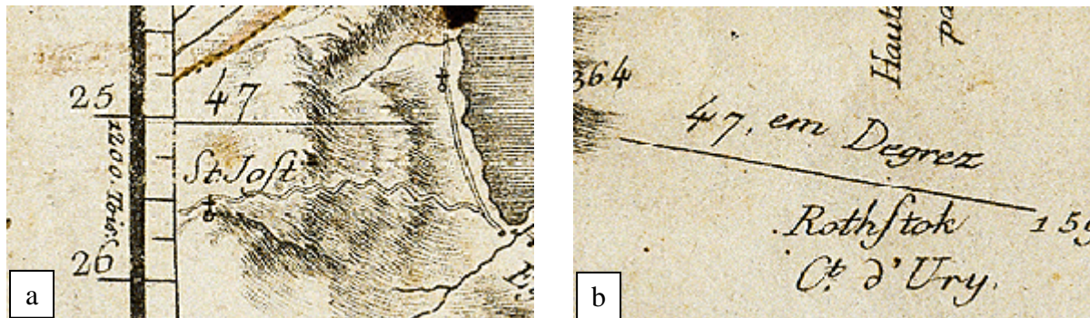
Abb. 6-13: Markierung des Breitengrades 47^\circ am linken und rechten Kartenrand der Carte en Perspective du Nord au Midi von Jakob Joseph Clausner (Anhang B5). Die Linien haben eine deutlich unterschiedliche Ausrichtung und lassen sich mit einer Gerade nicht zu einem Parallelkreis verbinden.
