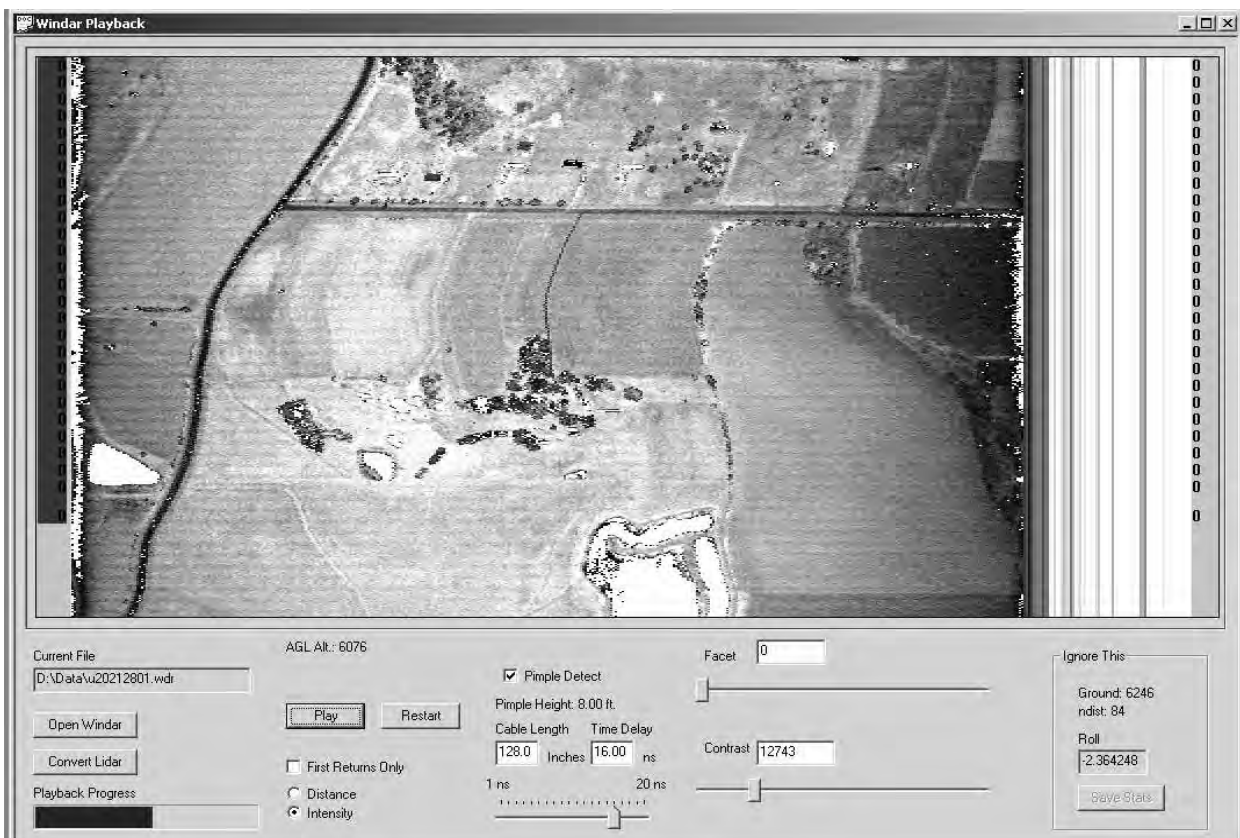
Abbildung 54 Beispiel eines Intensitätsbildes aus einem Flugstreifen (Playback-Modus)
