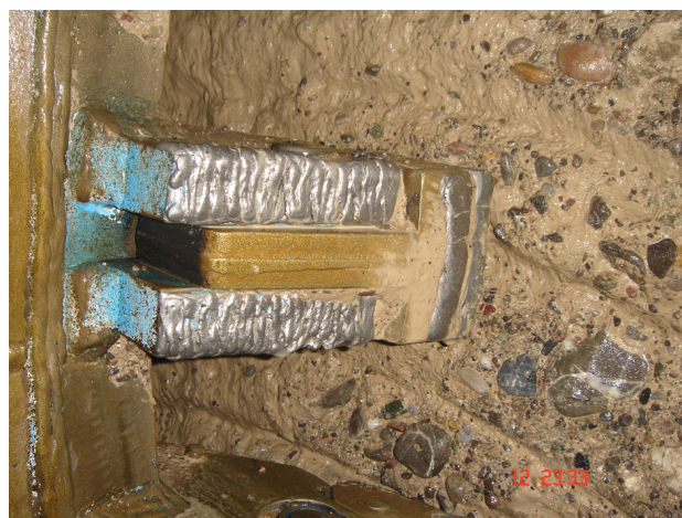
Abb. 36: Praktisch neuwertiges Schälmesser
