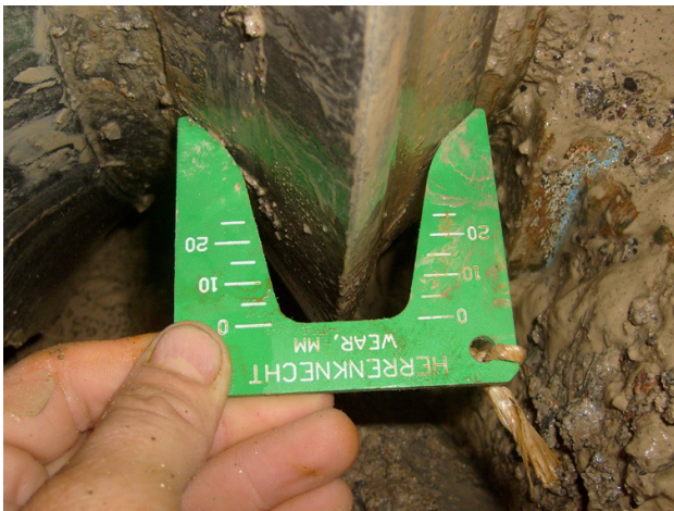
Abb. 37: Kontrolle eines Rollenmeissels
