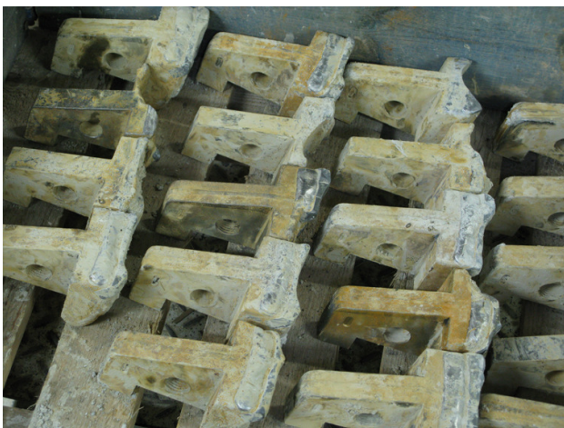
Abb. 38: Ausgewechselte, abgeschliffene Schälmesser
