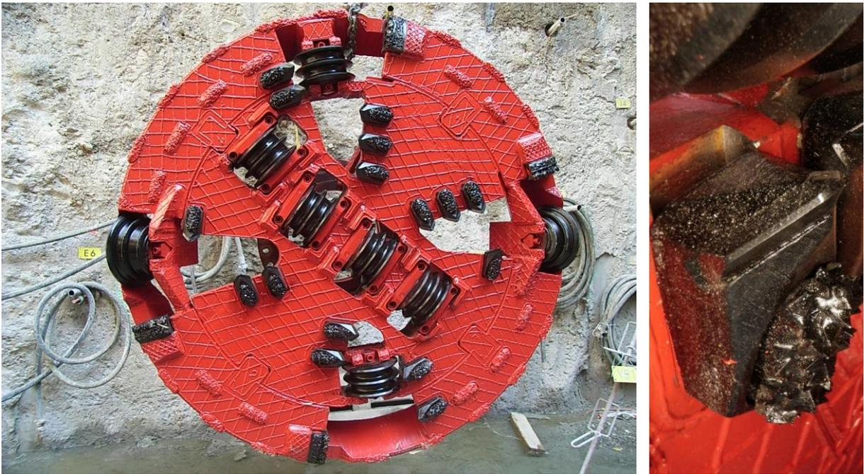
Bild 15 : Bohrkopf mit Spezialabbauwerkzeugen
