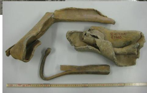
Bild 18 : Baustelle Bahnhofquai 1952 - Holzpfahl mit Stahlschuh / Spundwandteile
