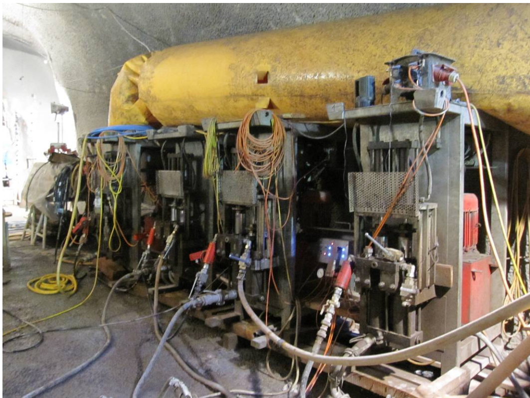
Bild 12: 4 Stk. Zementinjektionspumpen Typ DP90
