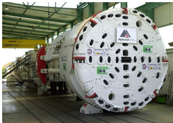
Fig. 13: TBM S-210 (S-211) Gotthard, Bodio-Faido
