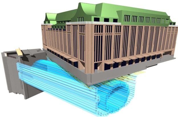
Da Setzungen und Stützenneigungen der Jugendstilfassade nur in sehr engen Grenzen toleriert werden, sind unmittelbar unter der Kaufhofgründung und oberhalb der oberen Gefrierrohrbohrungen 72 m lange Injektionsrohre angeordnet. Erwartete Setzung und Stützenneigungen, die durch den Tunnelvortrieb auftreten, werden durch gezielte Vorhebungen im Vorfeld kompensieren.
