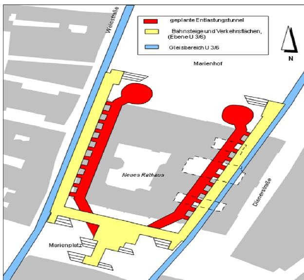
Dabei wurden die oberen tertiären wasserführenden Sande sowie Mergelschichten im Kalottenbereich der späteren Tunnel gefroren und damit für den Tunnelvortrieb wasserdicht abgesperrt. Das Grundwasser in den tieferen Sandlagen wurde mit 12 Brunnen (im gesamten Bereich Marienhof abgesenkt, so dass mit einem atmosphärischen Spritzbetonvortrieb die beiden 90 m langen Tunnelröhren aufgeföhren werden konnten. Das Grundwasser-Absenkziel wurde mit ca. 24 Pegeln überwacht.
