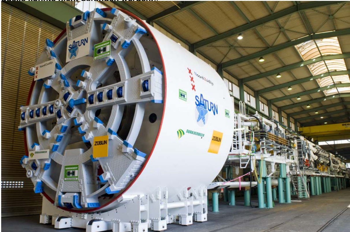
Bild 3: Mixschild Herrenknecht S-268
