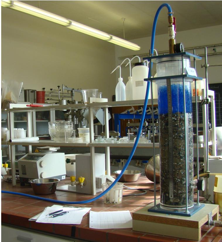
Bild 6 – Grobstückige Polymere im Stützdrucktest bei einer Durchlässigkeit von 10-2 m/s
