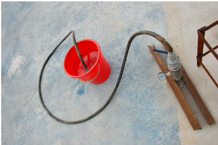
Bild 2 – Luftbrunnen unter dünner Asphaltdecke in China
