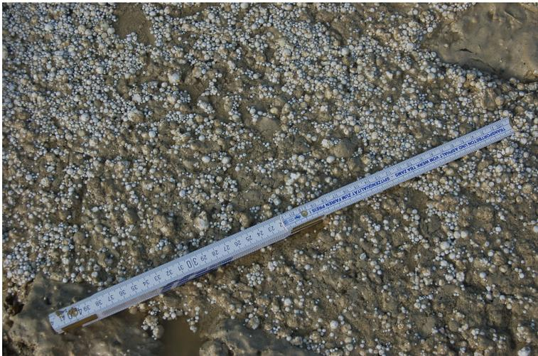
Bild 5 – Styroporkugeln in der Suspension
