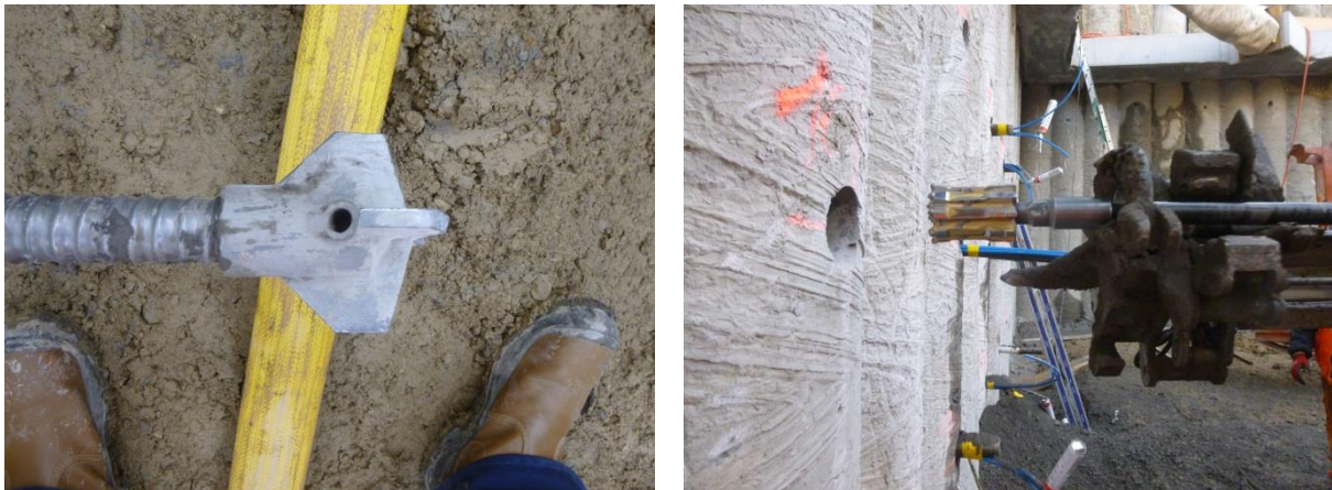
Abbildungen 7 und 8 – Ausgetestete Bohrkronen. Links: Flügelbohrkrone, 115 mm. Rechts: Stiftbohrkrone mit Rückschneide, 115 mm.
