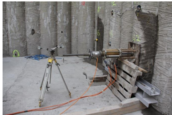
Abbildungen 9 und 10 – Ankerversuche. Links: vorbereitete Versuchsanker aus GFK, von links: Stabanker, 3-Lamellen-Anker, Y-Anker. Rechts: Ankerversuch im Voreinschnitt, Presse und Stativ für Messuhren
