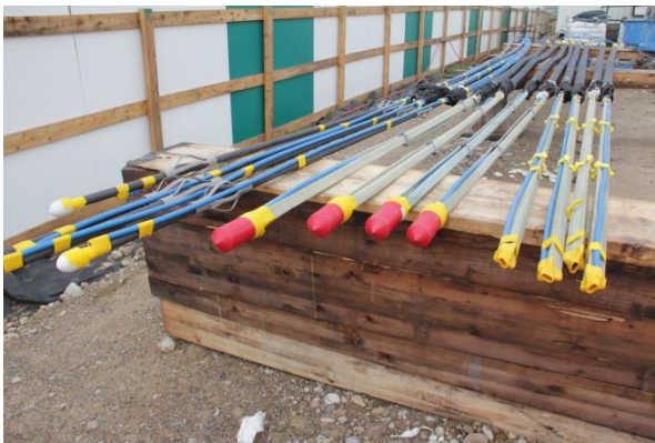
Abbildungen 9 und 10 – Ankerversuche. Links: vorbereitete Versuchsanker aus GFK, von links: Stabanker, 3-Lamellen-Anker, Y-Anker. Rechts: Ankerversuch im Voreinschnitt, Presse und Stativ für Messuhren
