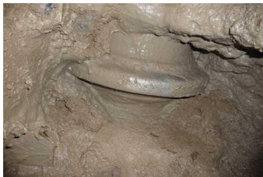
Schneidrollen im Boden
