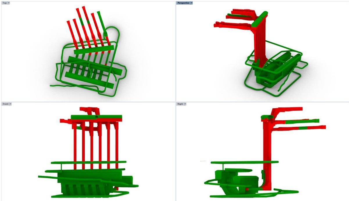
**Abb. 3-1: Triebwasserwege und Hauptkavernen im 3d Modell. Grün - gebaut, rot - in Ausführung.**
