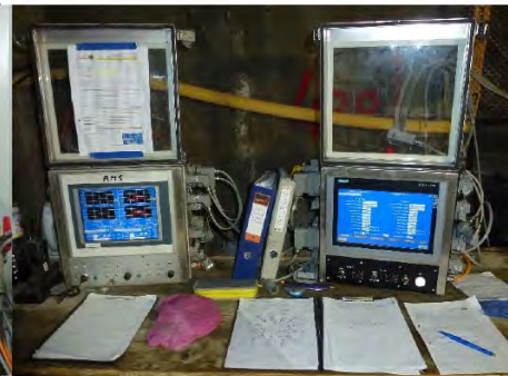
PC-Steuereinheit mit Software; linker Bildschirm: RMS2 (Datenaufzeichnung); rechter Bildschirm: Fördermengenregulator (Bestimmung der Menge an PU)
