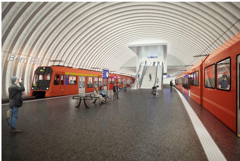
Bild 5: Bahnhofskavernen – Visualisierung des Gewölbes mit rippenartiger Struktur [2]
