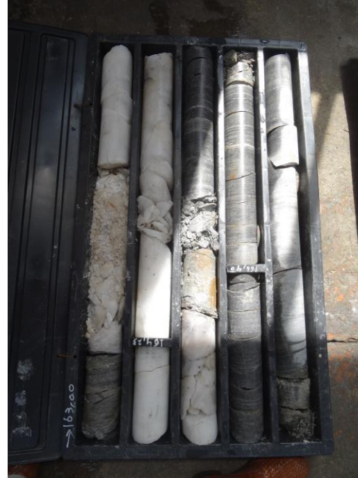
Sondierbohrung SB-05 in Piora Schrägbohrung L = 750 m für einen genauen Aufschluss der geolog. und hydro-geologischen Verhältnisse im Schrägschacht
