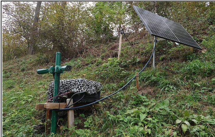
Wärmebildkameras für die Überwachung der Streckenabschnitte aus [5]
