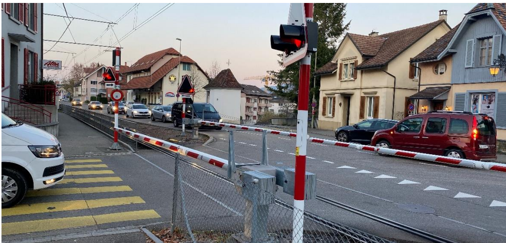
Abbildung 5: Bildung Rückstau auf allen Zufahrtsstrassen aufgrund Blockade durch Barrieren
