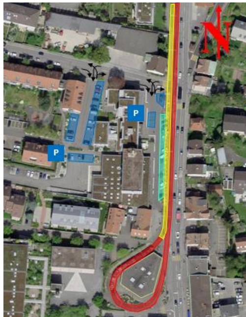
Abbildung 25: Variante Doppelspurausbau Tramlinie bestehendes Gleis (rot), zweites Gleis (gelb), abzubauende (hellblau) und zu benutzende Parkplätze (dunkelblau) [7]
