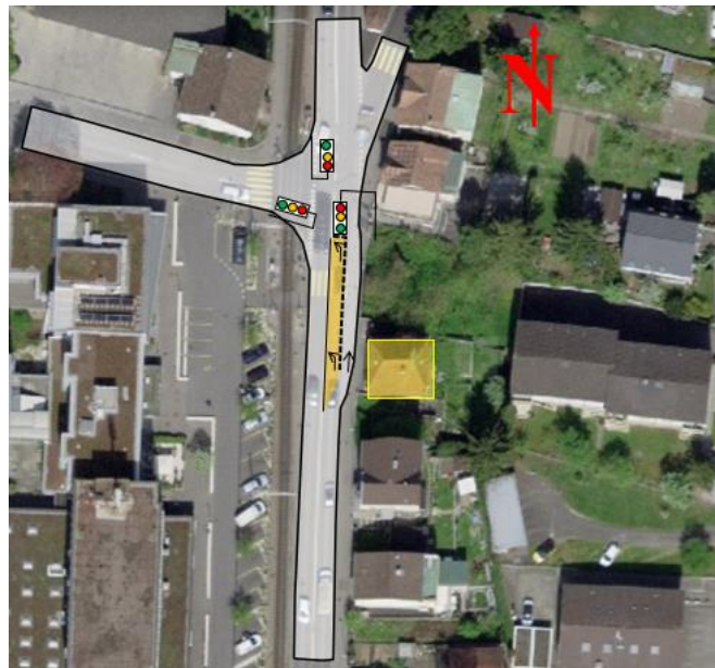
Abbildung 24: Variante Spurerweiterung mit LSA Spurerweiterung (orange), abzureissendes Wohnhaus (gelb) [7]
