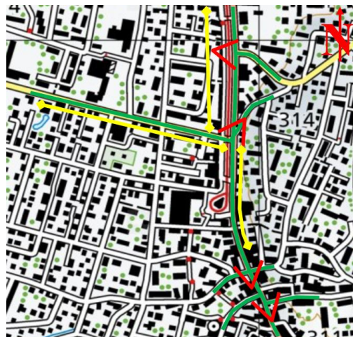
Abbildung 8: Standorte Kameras für Videoerhebung und Zuflussstrassen mit Rückstauermessung [7]
