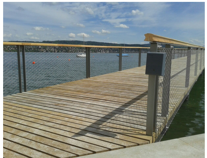
Abb 1: Automatische Zählstelle für den Fussverkehr (Infrarotsensor). Das Gerät zeichnet sich durch eine hohe Messgenauigkeit aus und ist mobil einsetzbar. Hier misst es die Personenfrequenzen auf dem neu gebauten Cassiopeiasteg in Zürich. Quelle: Stadt Zürich, Tiefbauamt
