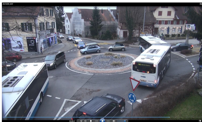
Abb. 2: Knotenstromerhebung mit einem digitalen Video an einem Kreislauf in Fällanden ZH. Die filmbasierte Erhebung bietet sich bei hohen Verkehrsbelastungen an, weil bei der Auswertung gestoppt und zurückgespult werden kann. Zusätzlich ermöglichen Filmaufnahmen, Konfliktsituationen zu identifizieren. Bild: ewp
