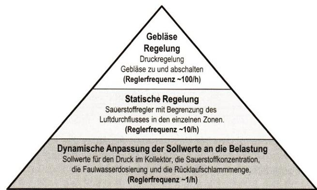
Abb. 8: Verallgemeinertes Konzept des Gleitdruckreglers. Vorschlag für die Kaskadierung der Regelkreise und typische Regelfrequenzen
