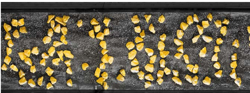
Abb. 20: Situation auf dem mittleren Abschnitt der aufgelösten unstrukturierten Blockrampe im Modell nach einer Belastung von q = 60 \text{ l/sm}^2 .
