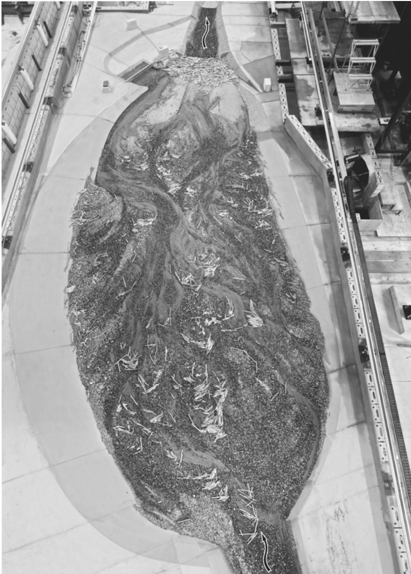
Abb. 17: Situation im Sammler nach einem HQ_{300} mit 60'000 \text{ m}^3 Geschiebe und 1'000 \text{ fm}^3 Schwemmholz.
